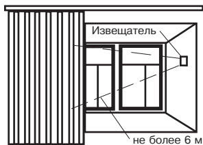
Установка извещателя между стеклом и занавесями (жалюзи)
