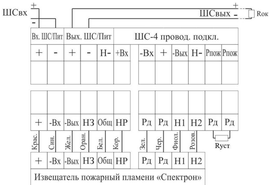
Рис. А1 – Схема подключения по 2-х проводной линии связи без функции «Неисправность»
