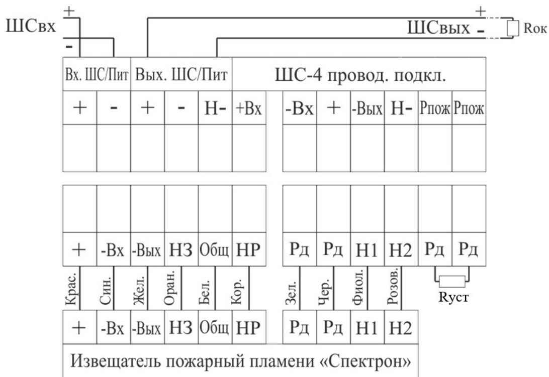
Рис. А2 – Схема подключения по 2-х проводной линии связи с функцией «Неисправность»
