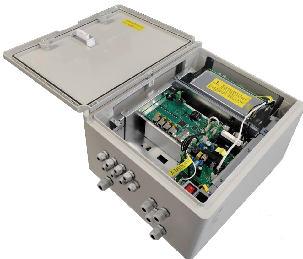
Рисунок 3.1.2 - PSW-2G+UPS-Box - вид внутри
