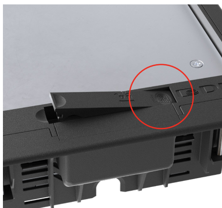
Для того, чтобы открыть крышку лючка, нажимаем пальцем на ручку
