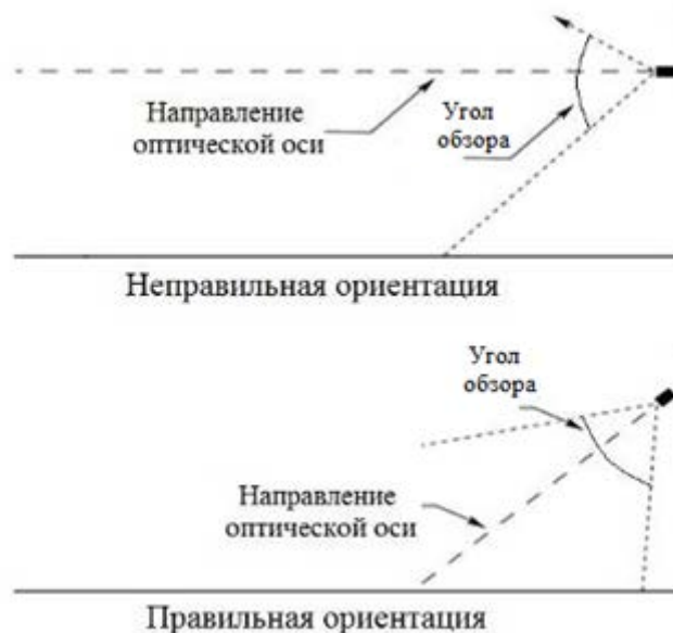
Рисунок 2 – Установка извещателя по отношению к горизонту
