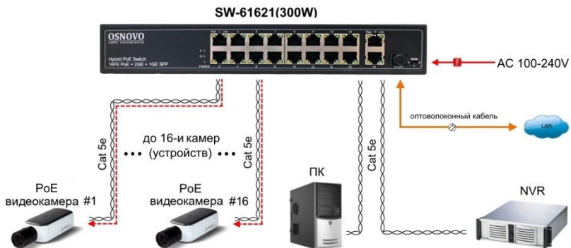
Рис.4 Типовая схема подключения коммутатора SW-61621(300W)
