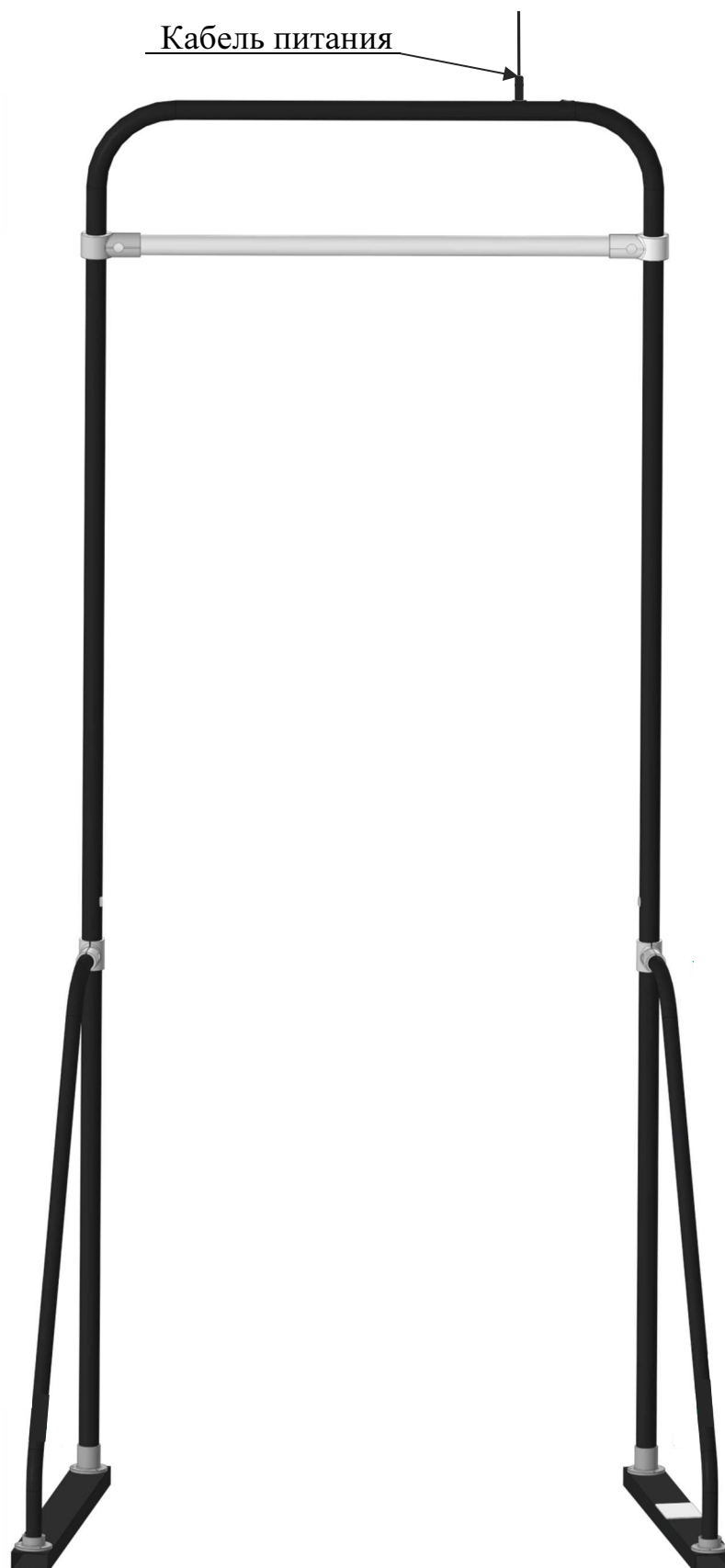
Рисунок 2.2 – Рекомендуемое подключение блока питания (адаптера)
