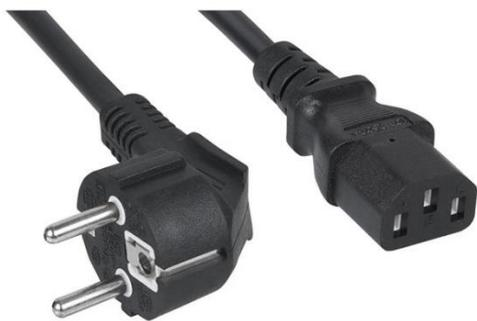
Кабель питания PC-186-VDE-xx предназначен для подключения электрооборудования к электрической сети переменного тока. Имеет опрессованную розетку IEC 320 C13 и вилку CEE 7/7 (Schuko). Кабель состоит из трех многожильных проводов сечением 0,75 мм<sup>2</sup>, имеет заземление. Номинальный ток нагрузки: 10А. Номинально напряжение: 220-250 В. Длина кабеля составляет 0,6; 1,2; 1,8; 3; 5 метров в зависимости от модели.
