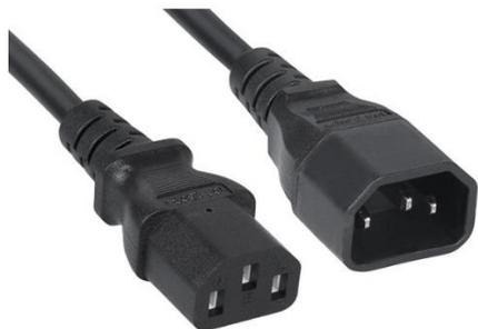
Кабель питания PC-189-VDE-xx предназначен для подключения электрооборудования к электрической сети переменного тока. Имеет опрессованную розетку IEC 320 C14 и вилку IEC 320 C13. Кабель состоит из трех многожильных проводов сечением 0,75 мм<sup>2</sup>, имеет заземление. Номинальный ток нагрузки: 10А. Номинально напряжение: 220-250 В. Длина кабеля составляет 0,6; 1,2; 1,8; 3; 5 метров в зависимости от модели.
