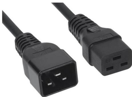
Кабель питания PC-IEC19- IEC20-xx предназначен для подключения электрооборудования к электрической сети переменного тока. Имеет опрессованную розетку IEC 320 C19 и вилку IEC 320 C20. Кабель состоит из трех многожильных проводов сечением 1,5 мм<sup>2</sup>, имеет заземление. Номинальный ток нагрузки: 16А. Номинально напряжение: 220-250 В. Длина кабеля составляет 1,8; 3; 5 метров в зависимости от модели.
