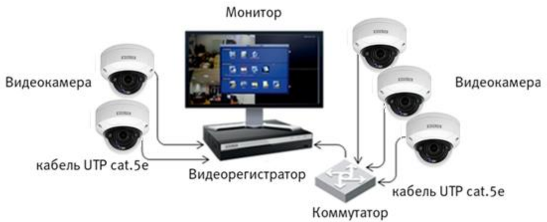
Рисунок 6.5 – Схема подключения видеокамеры к видеорегистратору
