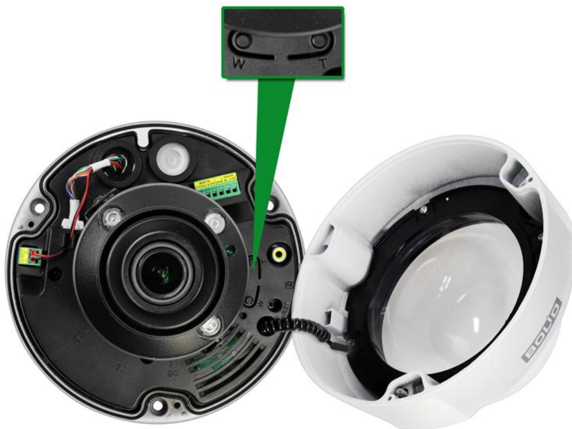
Рисунок 5.15 – Настройка фокусного расстояния вручную
