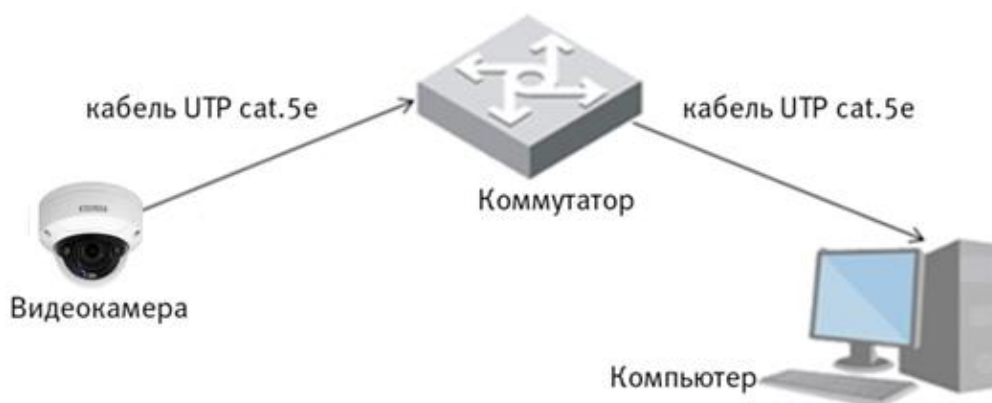
Рисунок 6.4 - Схема подключения видеокамеры к компьютеру через коммутатор
