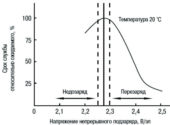
Рис. 8 Зависимость срока службы аккумулятора от напряжения подзаряда
