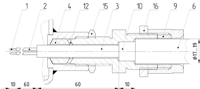
**Рис. Б.4 Небронированный кабель в металлорукаве в внешнем диаметром 17..19мм в штуцере ШБМ-Ехd**
