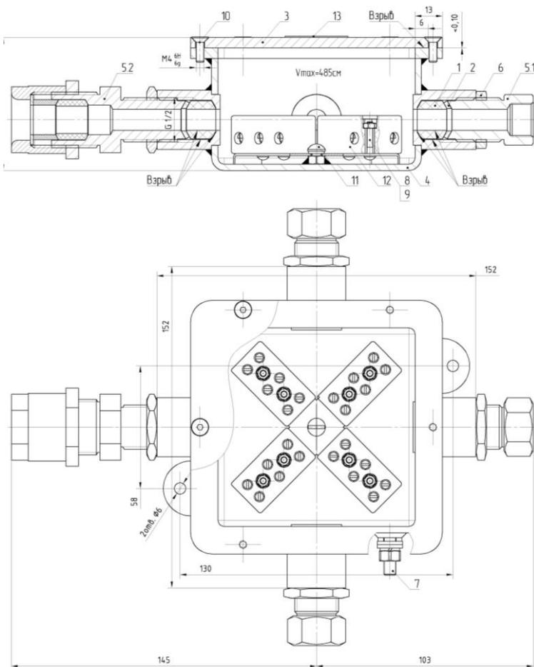
1 Кольцо. 2 Шайба. 3 Крышка. 4 Корпус. 5.1 Штуцер ШП-Ехд с внутренней резьбой М16х1.5. 5.2 Штуцер ШБМ-Ехд под бронекабель. 6 Контргайка. 8, 9 Винт и Гайка крепления клеммной колодки. 10 Винт под шестгр. ключ 3 мм. 11 Винт и Шайба крепления блока клеммных колодок. 12 Колодка клеммная. 13 Табличка.
