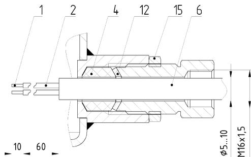
Рис. Б.7 Глушение неиспользуемого кабельного ввода
