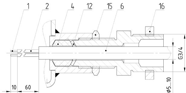
Рис. Б.6 Небронированный кабель в штуцере ШП-Ехд
