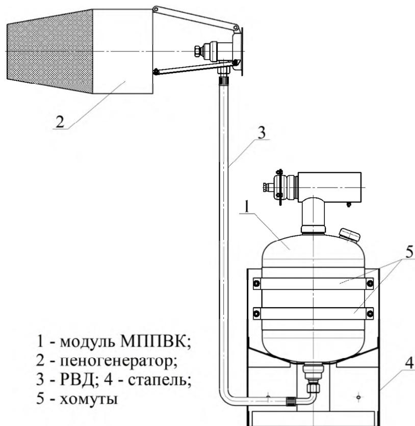
Рисунок 10 - МППВК с горизонтальным расположением эжектора
