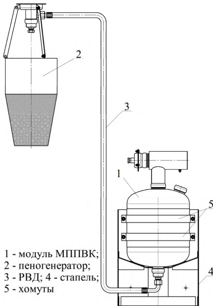
Рисунок 9 - МППВК с вертикальным расположением эжектора
