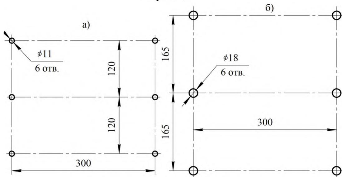
Координаты отверстий: а) - для крепления на полу;
