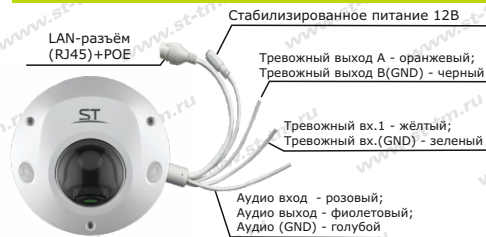
Рис.1 Схема подключения видеокамеры
