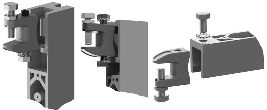
Держатель 152 имеет симметричную (продублированную) конструкцию в зоне крепления блоков и рефлекторов-отражателей, что позволяет его крепить к ребру балки (швеллера) при необходимости как снаружи, так и изнутри (для соблюдения вертикальной геометрии положения).
