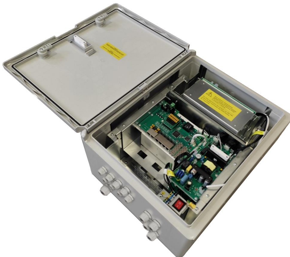
Рисунок 3.1.2 - PSW-2G6F+UPS-Box - вид внутри
