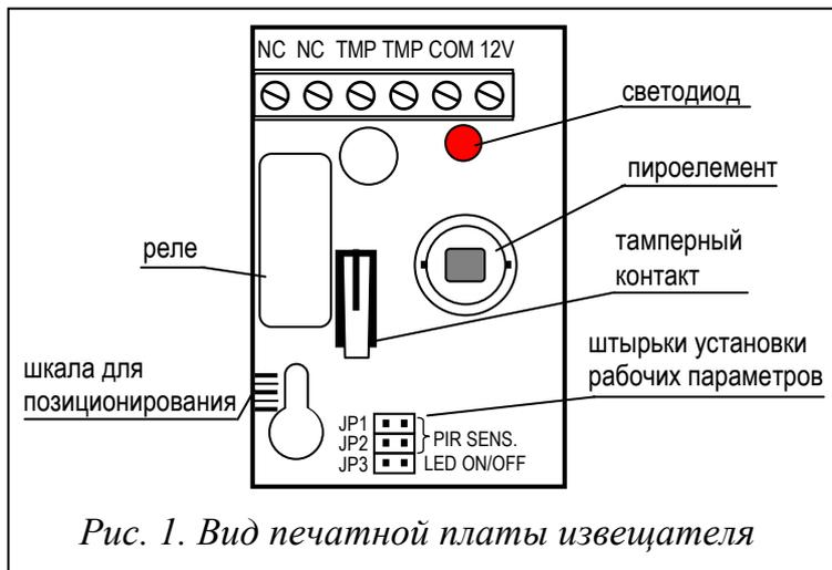
Три пары штырьков предназначены для установки рабочих параметров извещателя (см. таблица).
