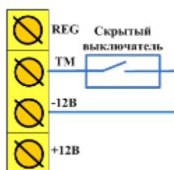
Рисунок 3.4 — Схема подключения скрытого выключателя
