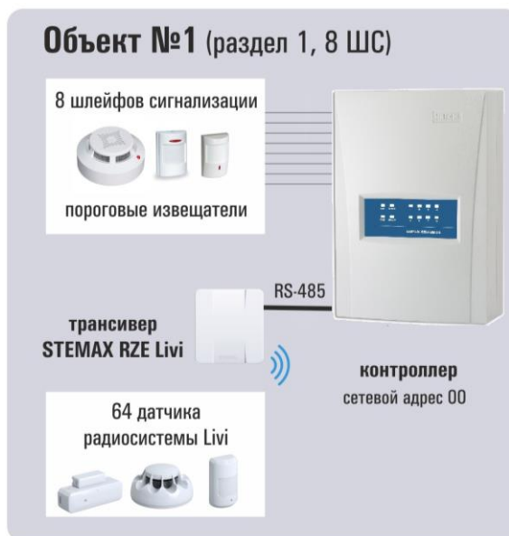
Рисунок 3.6 – Пример топологии сети RS-485 объектового оборудования при использовании трансивера STEMAX RZE Livi
