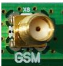
Рисунок 3.1. SMA-разъем для подключения GSM-антенны
