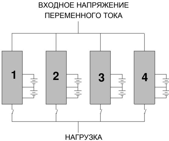
Рисунок 24 — Схема подключения изделий в систему параллельного резервирования.
