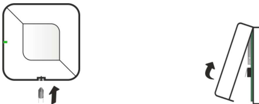
Рисунок 4.17 – Вскрытие корпуса ретранслятора Livi RTRM
