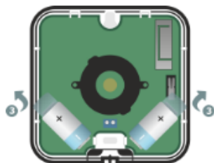
Рисунок 4.23 – Снятие защитных пленок с батарей сирены
