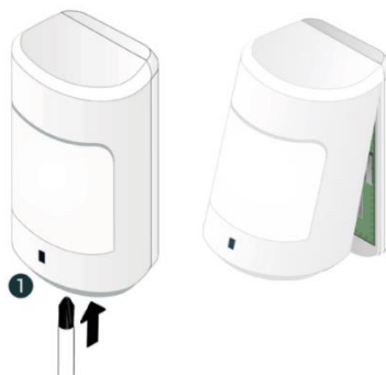
Рисунок 4.1 – Вскрытие корпуса датчика движения
