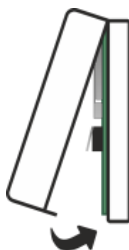
Рисунок 4.24 – Закрытие корпуса сирены
