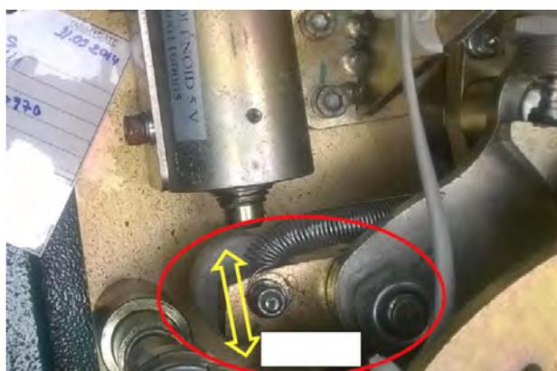
Движение рычага блокировки должно быть свободным и плавным. Очистите и нанесите легкое машинное масло, если стопорный рычаг заедает.
