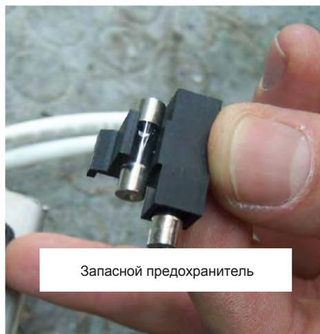
Рабочий и запасной предохранители расположены внутри сетевой розетки.
