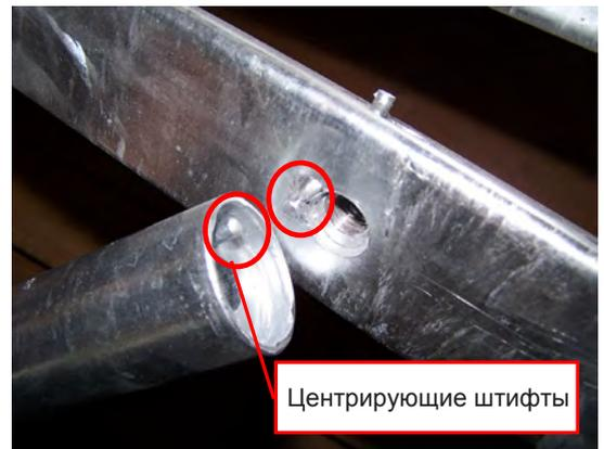
Прикрепите рычаги к ротору и поверните против часовой стрелки, пока не защелкнутся стопорные штифты, чтобы предотвратить снятие рычагов при повороте. Полностью затяните болты кронштейнов, примените клей для резьбовых соединений (loctite или аналог) и установите крышки кронштейнов, постукивая резиновым молотком.
