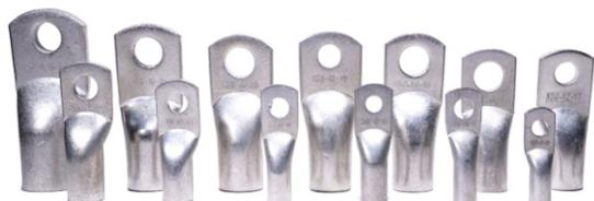
Наконечники кабельные медные лужёные ТМЛ используются для оконцевания проводов и кабелей с медными жилами сечением от 2,5 до 240 мм<sup>2</sup> и применяются для кабелей напряжением до 35 кВ. Наконечники закрепляются на жилах опрессовкой.
