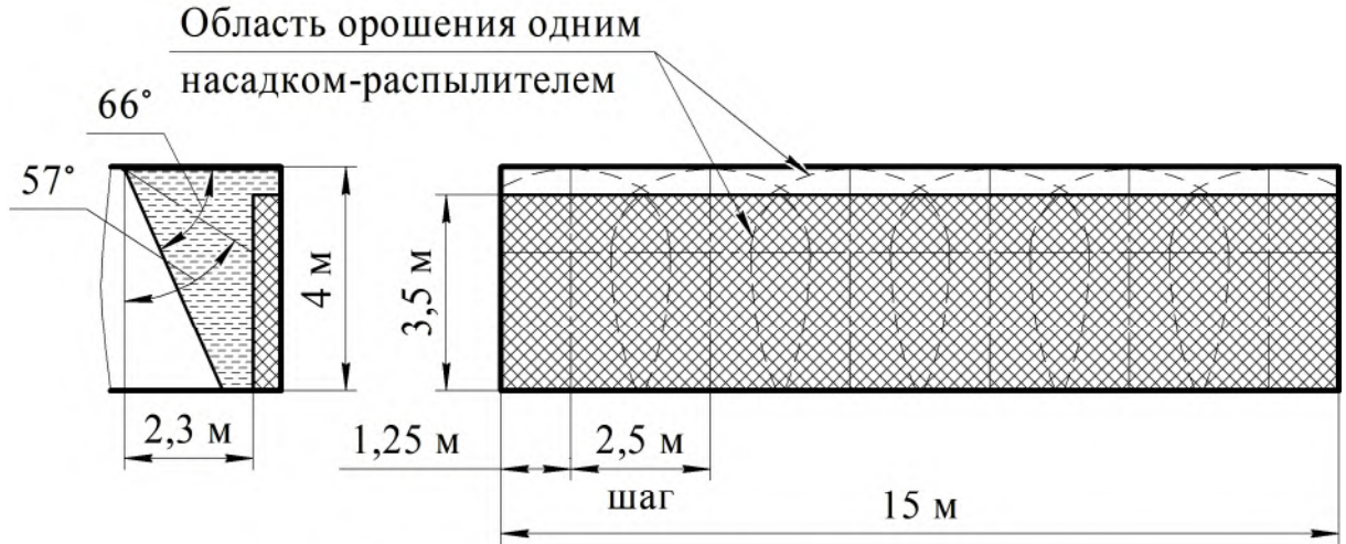
Рисунок 9. Противопожарная защита стеллажа 6-ю насадками-распылителями
