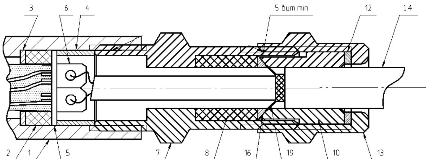
1 Корпус датчика; 2 Кольцо уплотнительное; 3 Шайба; 4 Прижимное кольцо; 5 Плата датчика; 6 Клемменный зажим; 7 Корпус ввода; 8 Уплотнитель контакта; 10 Штуцер; 12 Шайба; 13 Гайка; 14 Кабель; 16 Конус; 19 Броня
