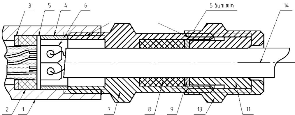
1 Корпус датчика; 2 Кольцо уплотнительное; 3 Шайба; 4 Прижимное кольцо; 5 Плата датчика; 6 Клемменный зажим;
