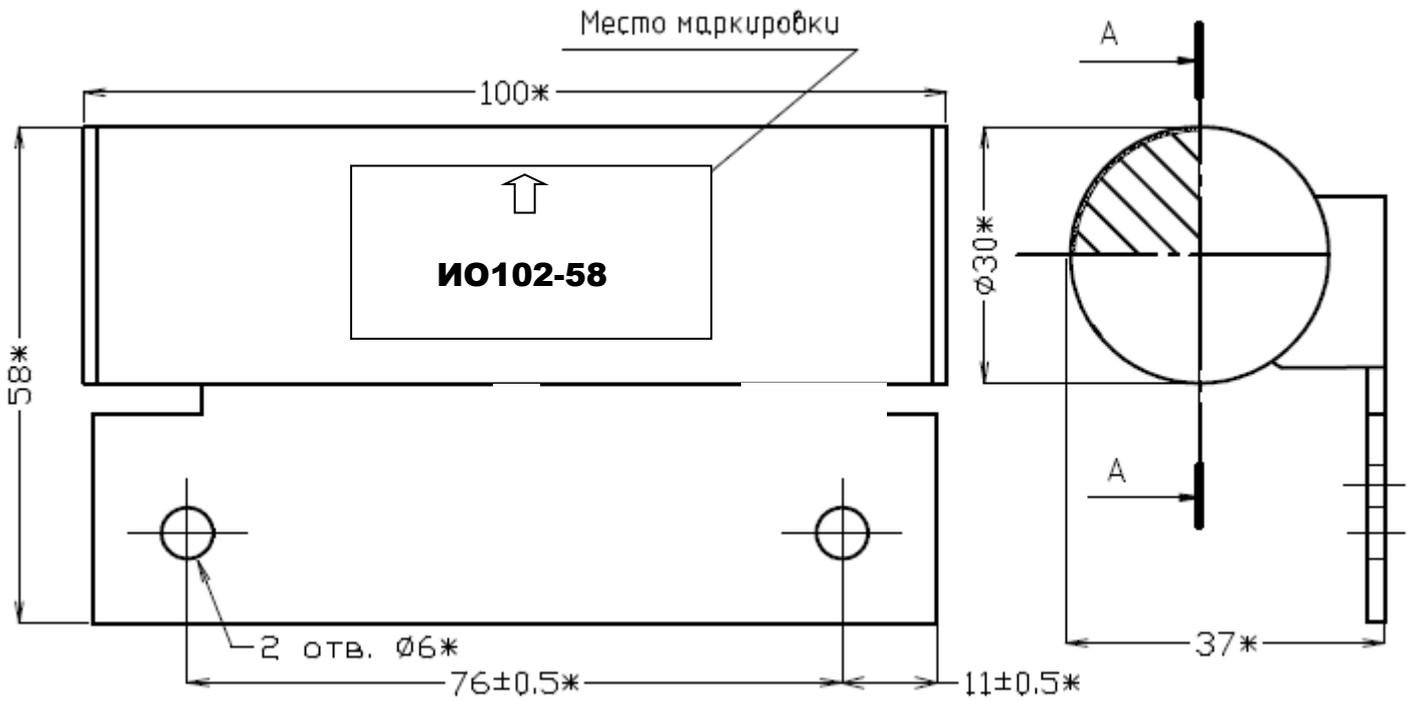
Рис.3 Габаритные и установочные размеры задающего блока ИО102-58
