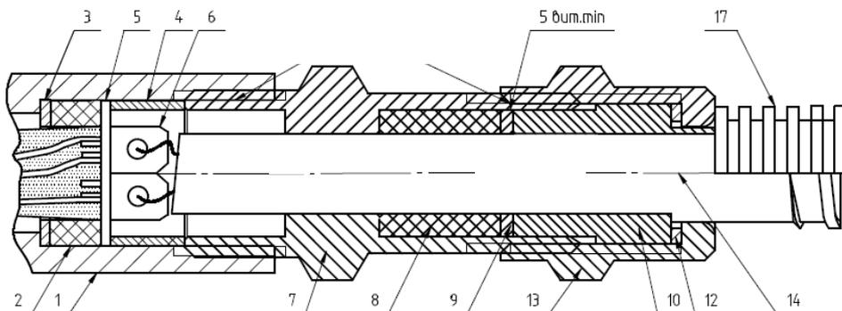
1 Корпус датчика; 2 Кольцо уплотнительное; 3 Шайба; 4 Прижимное кольцо; 5 Плата датчика; 6 Клемменный зажим; 7 Корпус ввода; 8 Уплотнитель кабеля; 9 Шайба; 10 Штуцер; 12 Шайба; 13 Гайка; 14 Кабель; 17 Металлорукав
