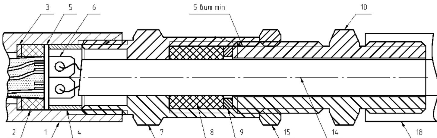
1 Корпус датчика; 2 Кольцо уплотнительное; 3 Шайба; 4 Прижимное кольцо; 5 Плата датчика; 6 Клемменный зажим; 7 Корпус ввода; 8 Уплотнитель кабеля; 9 Шайба; 10 Штуцер; 14 Кабель; 15 Контргайка; 18 Труба
