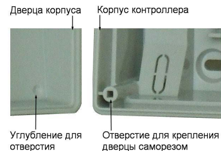
Рисунок 5. Схема «жесткого» крепления дверцы к корпусу контроллера
