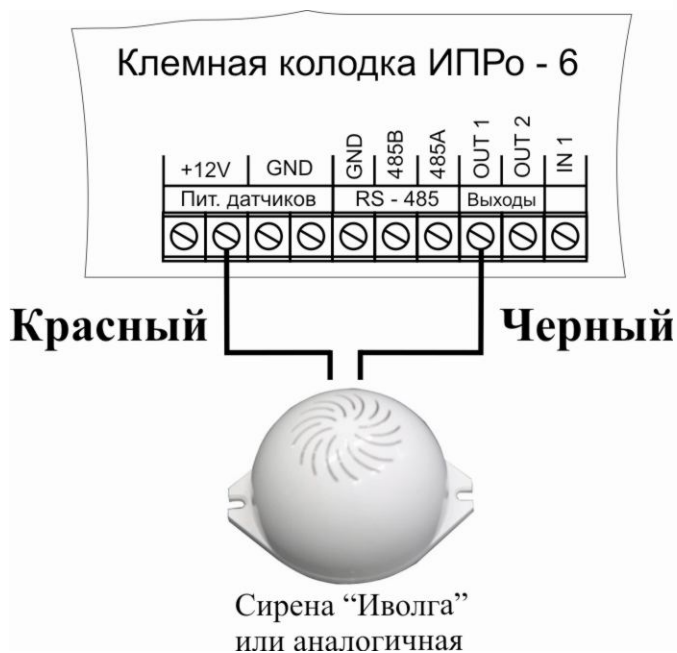
Подключение сирены с током потребления до 1А
