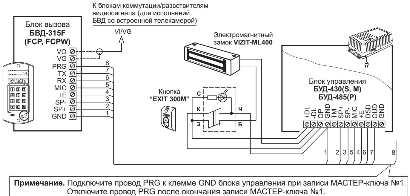
Рисунок 9 - Схема соединений блока вызова БВД-315F(FCP, FCPW) с блоком управления БУД-430(S, M), БУД-485(P), электромагнитным замком VIZIT-ML400 и кнопкой EXIT 300M
