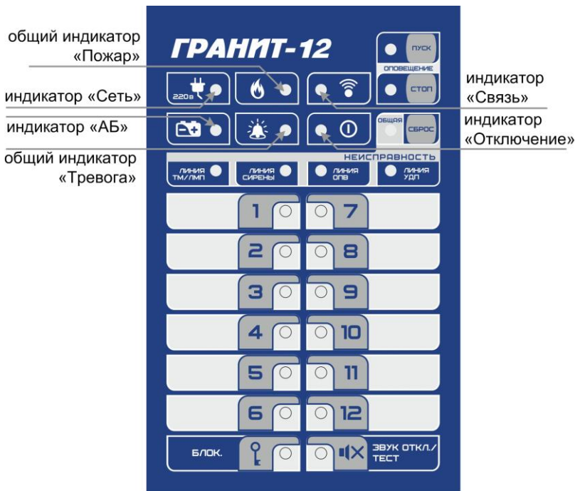
Рис.2 Панель индикации и управления прибора Гранит-12Л
