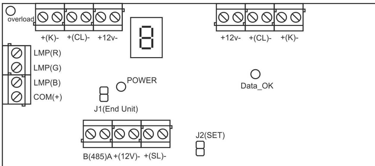
Рисунок 2. Внешний вид платы палатной консоли MP-331W1
