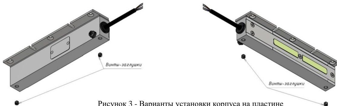
Рисунок 3 - Варианты установки корпуса на пластине
