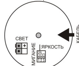
Рис.4 - Расположение клеммников и микропереключателей в коммутационном отсеке оповещателей «Плазма»Ex(m)-C-40x20
