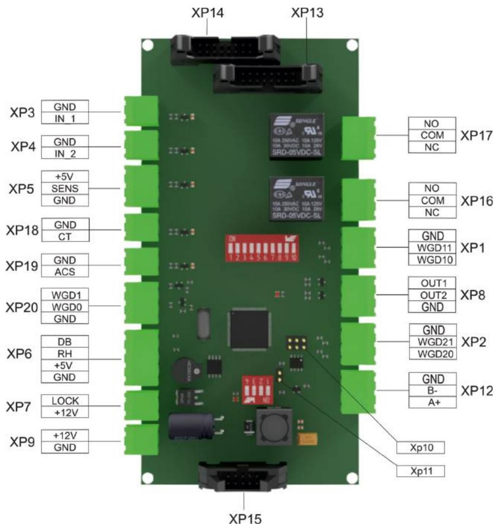
Рисунок 5.1.1 Управляющий контроллер картоприемника «KR-01EXT»
