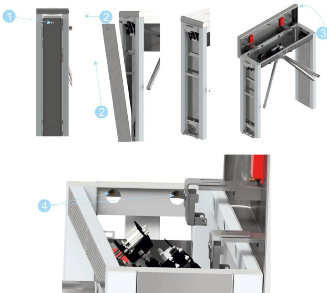
Рисунок 7.1.1 Снятие панели
