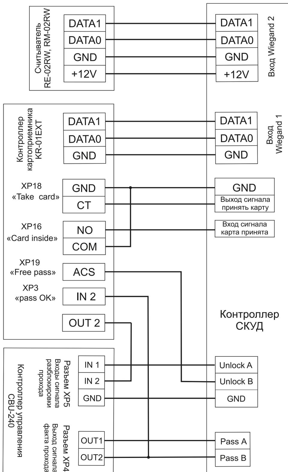
Рисунок 8.3 Типовая схема подключения «выход в направлении 2»
