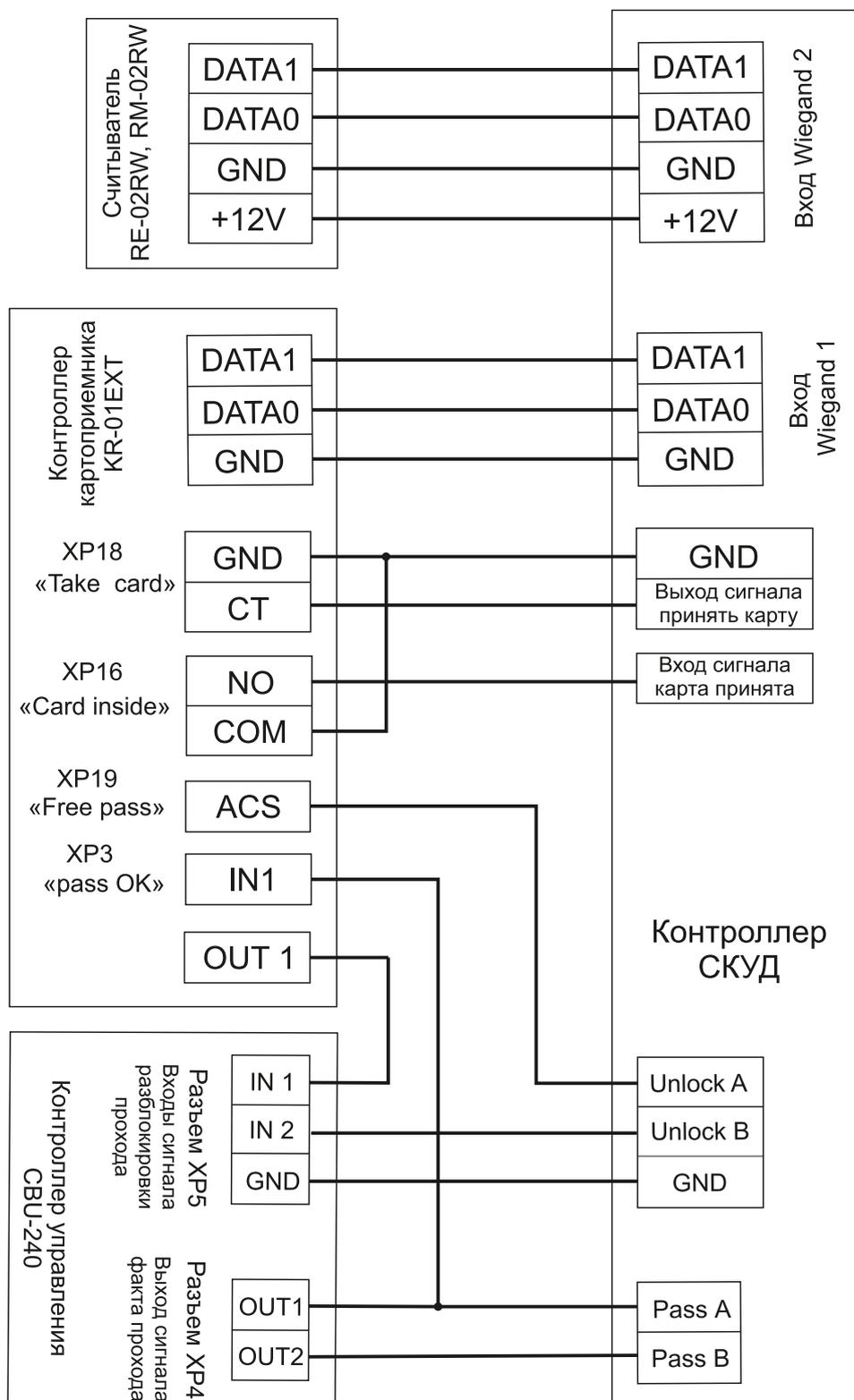
Рисунок 8.2 Типовая схема подключения «выход в направлении 1»
