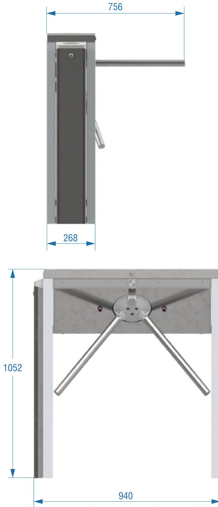
Рисунок 4.1 Габаритные размеры картоприемника «KL-03»
