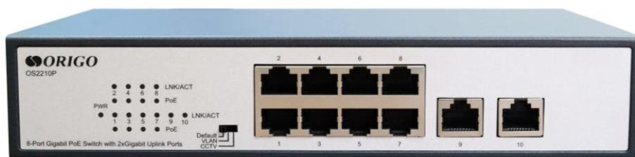
OS2210P/120W – 10-портовый гигабитный неуправляемый коммутатор с 8 портами PoE+ и общим PoE-бюджетом 120 Вт.
