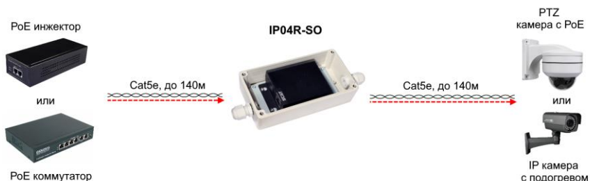
Рис.4 Типовая схема подключения удлинителя IP04R-SO.
