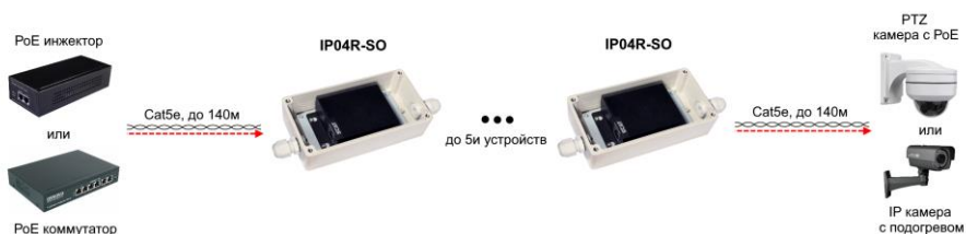
Рис.5 Каскадная схема подключения удлинителя IP04R-SO.
