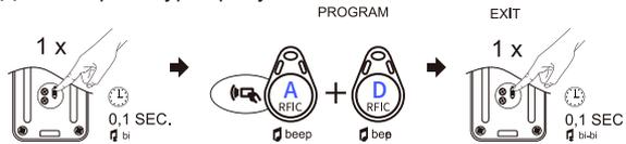
В. Длительное нажатие более 3-х секунд на кнопку контроллера, после тройного звукового сигнала, удалит все добавленные ранее ключи и карты. По окончании операции панель перейдет в дежурный режим.
