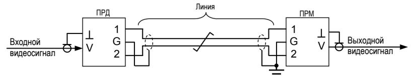
Рис.3 Схема включения АПВС-TV1 при невозможности заземления на передающей стороне
