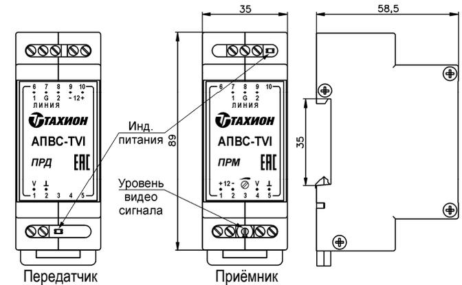
Рис.1 Устройство и габаритные размеры АПВС-TV1
