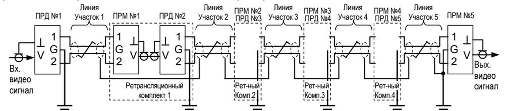
Рис.4 Схема построения линии с max длиной 1500 м, состоящей из пяти участков
