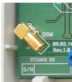
Рисунок 3.1 — SMA-разъем для подключения GSM-антенны
