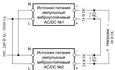
Последовательное подключение двух источников питания (с применением диодов Шоттки)
