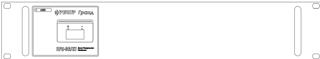
Рис.1 Лицевая панель блока БРП-36/7.
