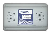
Радиоприемник MP-821W3 обеспечивает передачу сигналов от радиокнопки MP-411Q3 на компьютер с установленным ПО «HostCall-Quality» на расстояние до 100 м. Принимая сигнал от радиокнопки, радиоприемник передает принятый код через интерфейс RS-485 на персональный компьютер, который производит обработку поступивших данных.
