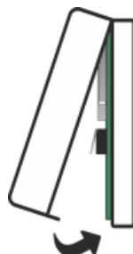
Рисунок 4.19 – Закрытие корпуса ретранслятора Livi RTRM
