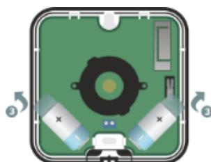
Рисунок 4.23 – Снятие защитных пленок с батареей сирены
