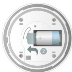
Рисунок 4.5 – Удаление защитной пленки
