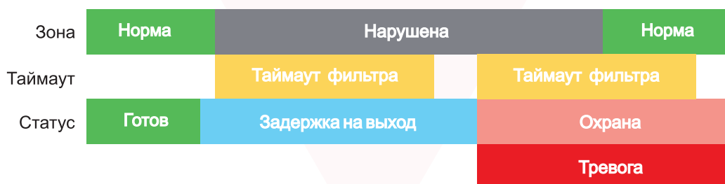
Рисунок 7. Нарушение зоны в момент постановки на охрану.
