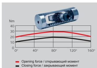
При использовании доводчика по принципу “шестерня-рейка” со скользящим каналом при открывании двери сопротивление нарастает непрерывно вплоть до 80°, что требует приложения гораздо больших усилий, чем в случае с доводчиком Cam Action
