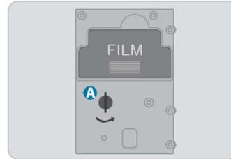
8. Отрегулируйте натяжение установленной плёнки для термопереноса в направлении стрелки с помощью Рукоятки натяжения на передней стороне держателя картриджа с плёнкой.
