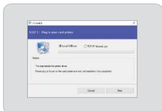
7. В случае USB-подключения нажмите «Далее» и перейдите к шагу 9. Если вы планируете настроить SMART-81 в качестве сетевого устройства, пожалуйста перейдите к шагу 8.
