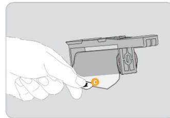
10. Снимите защитную пленку с чистящего ролика
