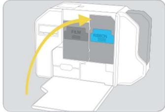
13. Закройте переднюю крышку принтера.
