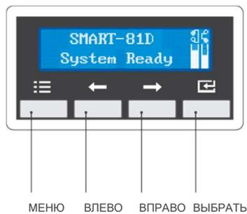
На лицевой стороне SMART-81 находится ЖК-дисплей и 4 кнопки. Пользователи могут проверить состояние принтера и изменить различные настройки принтера.
