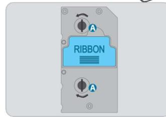
6. Отрегулируйте натяжение установленной ленты в направлении стрелки с помощью Рукоятки НАТЯЖЕНИЯ на передней стороне держателя картриджа с лентой.
