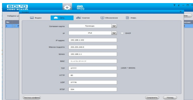
Рисунок 14.2 – Изменение IP-адреса с помощью утилиты «BOLID VideoScan»
