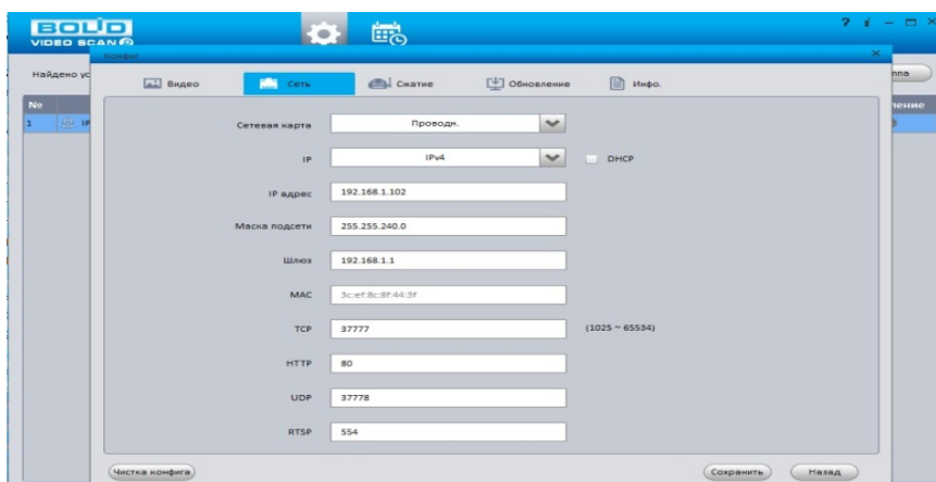
Рисунок 10.2 – Изменение IP-адреса с помощью утилиты «BOLID VideoScan»
