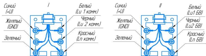
Рис. 2 Схема подключения устройства через телефонные розетки ТЭС-6С а) БК-04, вид со стороны расположения разъемов; б) подключение оборудования к контактам телефонной розетки
