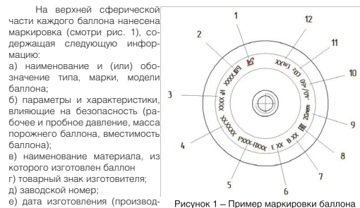
Рисунок 1 – Пример маркировки баллона
