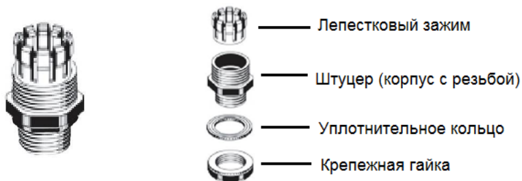
Рис.2 Устройство гермовводов
