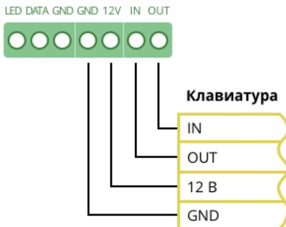
Подключается на клеммы группы «Клавиатура». (GND-GND, 12V-12v, IN-OUT, OUT-IN) .
