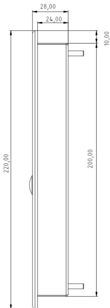
Рисунок 3 - Вид сбоку с указанием монтажного размера
