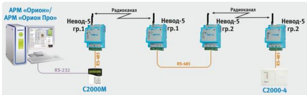
Для ретрансляции сигнала необходимо использовать дополнительно два модема. При этом на один входит в группу, в которую включен модем с пультом, а другой – в группу периферийных модемов.
